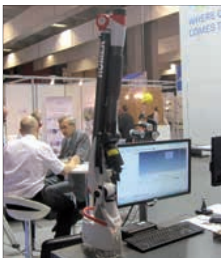
Véritables miniMMT, plus légers et polyvalents, les bras de mesure sont plébiscités par les utilisateurs. Ici celui de Hexagon Metrology dont la structure est en fibre de carbone. Source : MS
