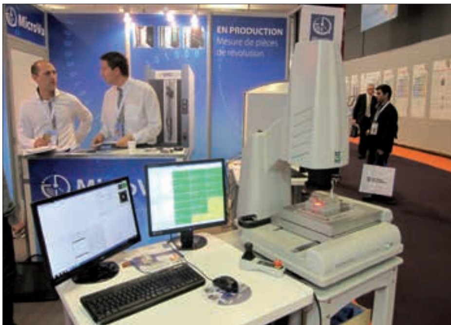
Les machines Vertex et Excel de MicroVu disposent d'un palpeur mécanique, d'un laser et d'un module de rugosité pour contrôler en production toutes les dimensions de la pièce ainsi que son état de surface. Source : MS
